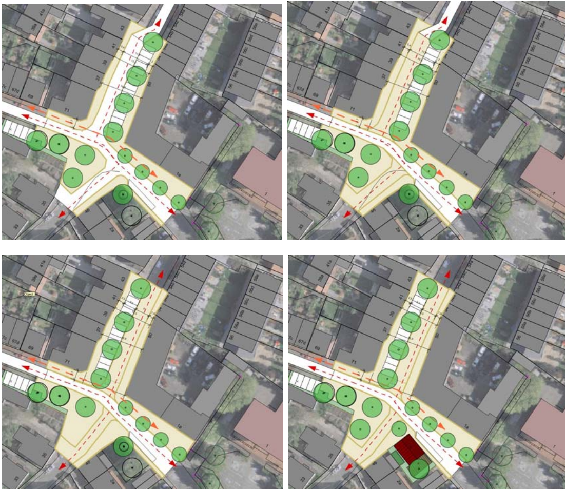
Erste Prinzipskizzen für die mögliche Neuordnung in Varianten (Flächenaufteilung, Verkehrsführung) noch ohne konkrete Aufteilung der Stellplatzflächen
